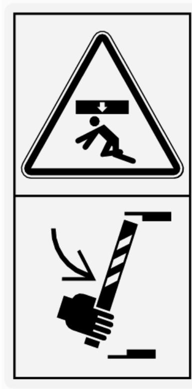
Рисунок 3.20 - Установите опору, прежде чем войти в опасную зону (PCM-10Б.22.01.005)
