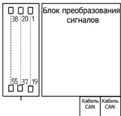
Рисунок 6.59 – Выходы и разъемы БПС-04
