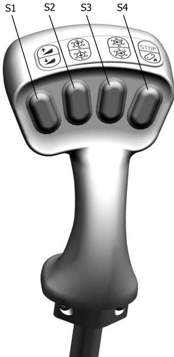
S1 – подъем/опускание наклонной камеры; S2 – подъем/опускание мотовила; S3 – перемещение мотовила вперед/назад; S4 – включение/выключение привода наклонной камеры
