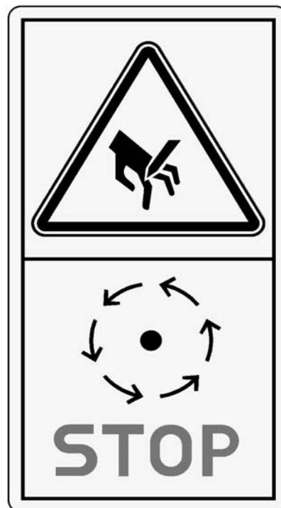
Рисунок 3.44 - Ждите, пока все части машины не остановятся полностью, перед тем, как касаться их (10Б.22.01.008)
