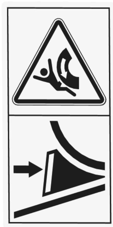
Рисунок 3.30 Противооткатные упоры
