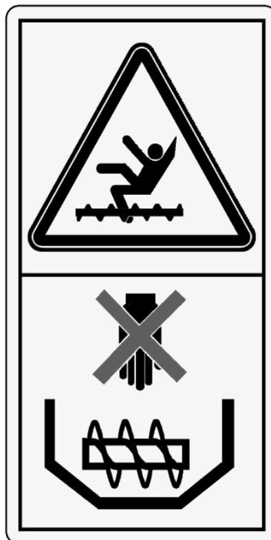
Рисунок 3.41 - Не приближайтесь или не прыгайте в бункер для зерна при работающем двигателе (10Б.22.01.007)
