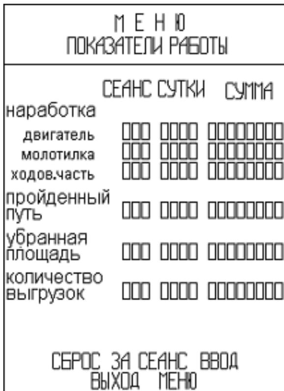
Рисунок 4.16 - Пример вида экрана в режиме "ПОКАЗАТЕЛИ РАБОТЫ"
