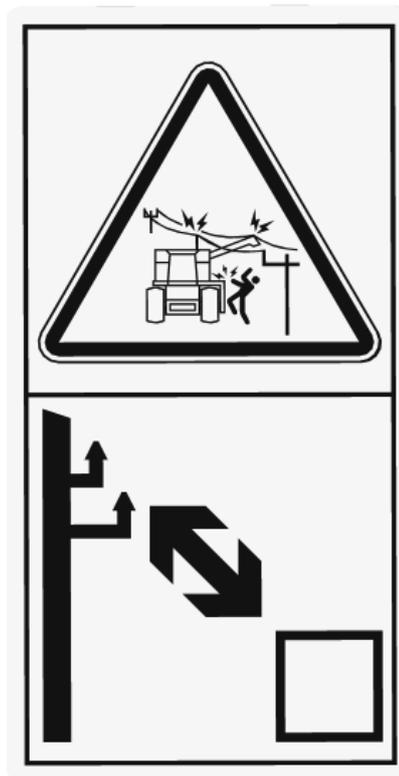
Рисунок 3.38 - Сохраняйте безопасную дистанцию от линии электропередачи (PCM-142.22.03.25)
